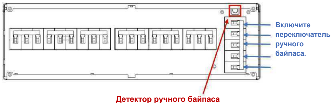
Рис. 8-2. Включение переключателя ручного байпаса БРП
