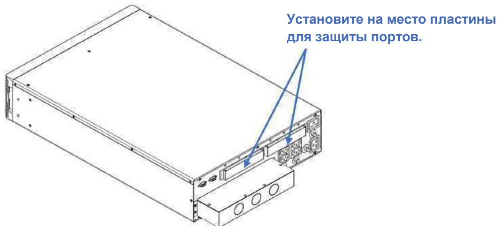
Рис. 8-6. Повторная установка пластин для защиты портов на задней панели БРП
