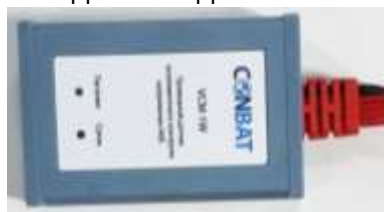
Проводной датчик поэлементного контроля № 7
