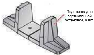
Рисунок 6-3. Сборка подставок для вертикальной установки ИБП 5/ 6/ 8/ 10 кВА
