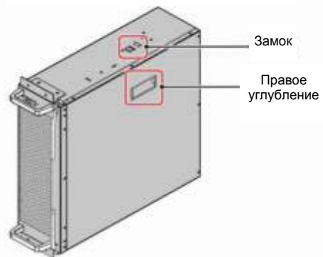
Рисунок 5-30: Расположение замка и боковых углублений
