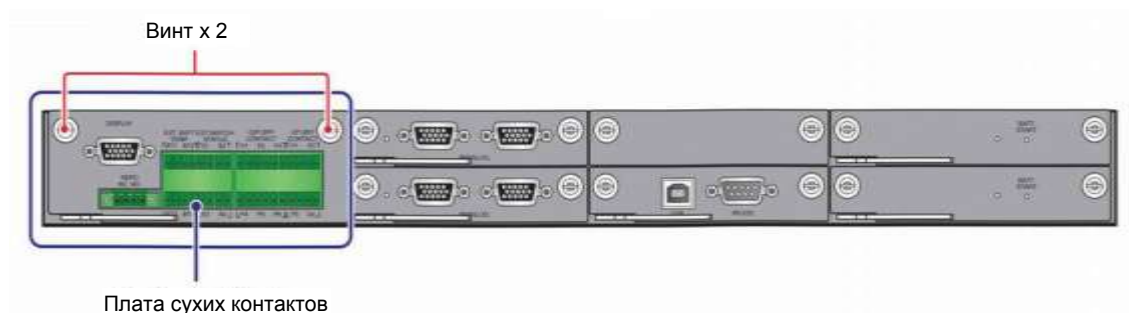
Рисунок 4-5: Расположение платы сухих контактов
