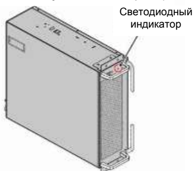
Рисунок 5-31: Расположение светодиодного индикатора модуля STS
