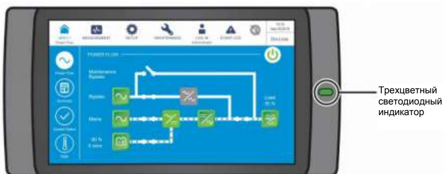
Рисунок 2-11: Расположение трехцветного светодиодного индикатора
