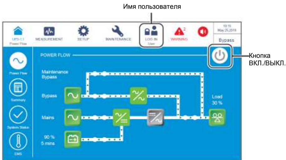
Рисунок 6-18: Экран режима байпаса: расположение кнопок имени пользователя и ВКЛ./ВЫКЛ.
