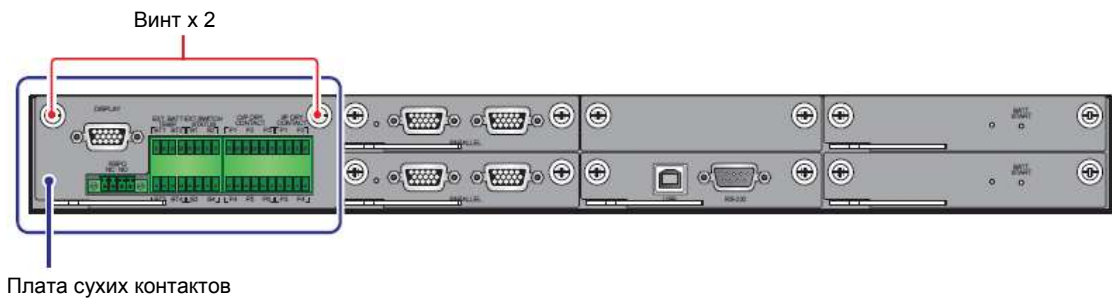
Рисунок 4-5: Расположение платы сухих контактов
