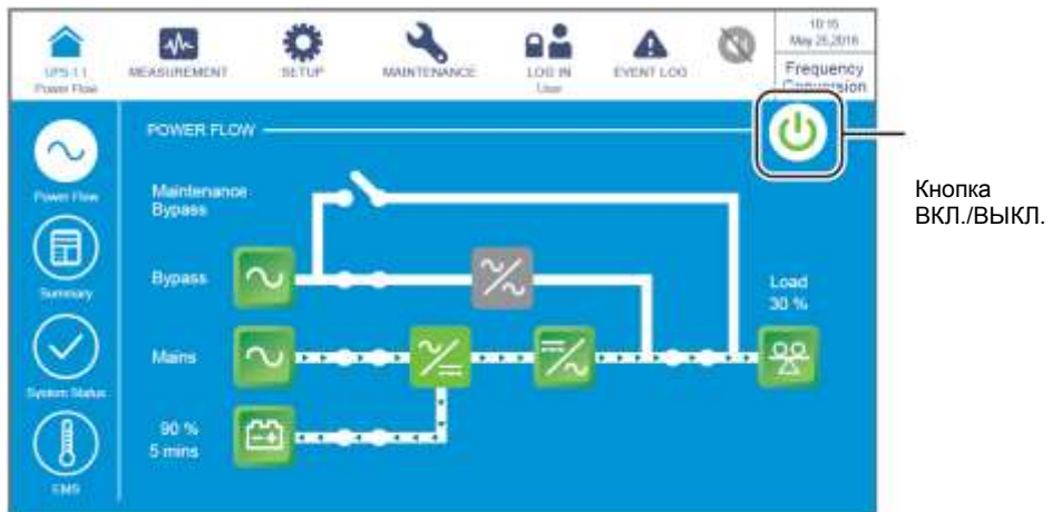
Рисунок 6-57: Экран режима преобразования частоты и кнопка ВКЛ./ВЫКЛ.
