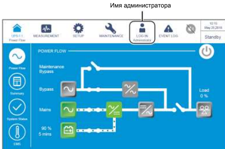
Рисунок 6-60: Экран режима ожидания и имя администратора
