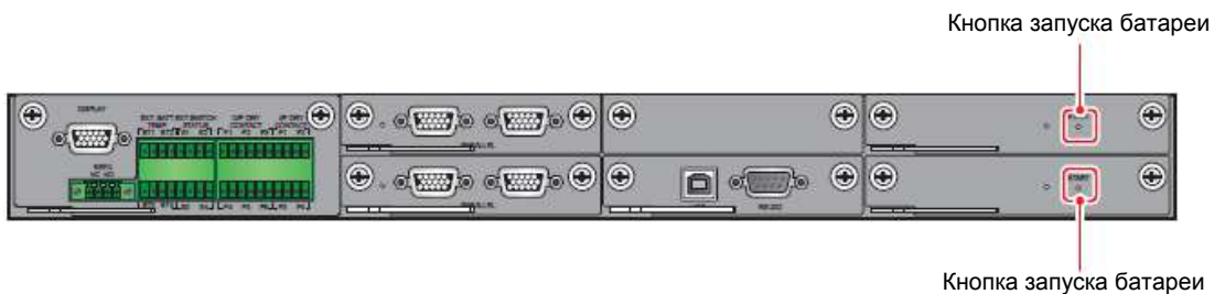
Рисунок 4-16: Расположение кнопок запуска батарей
