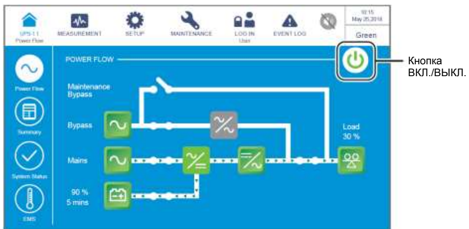
Рисунок 6-62: Экран энергосберегающего режима и кнопка ВКЛ./ВЫКЛ.
