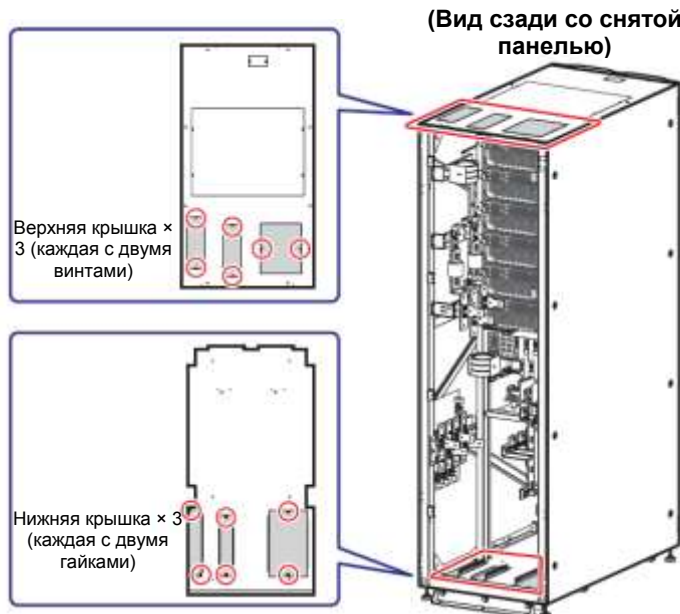
Рисунок 5-14: Расположение верхней и нижней панелей
