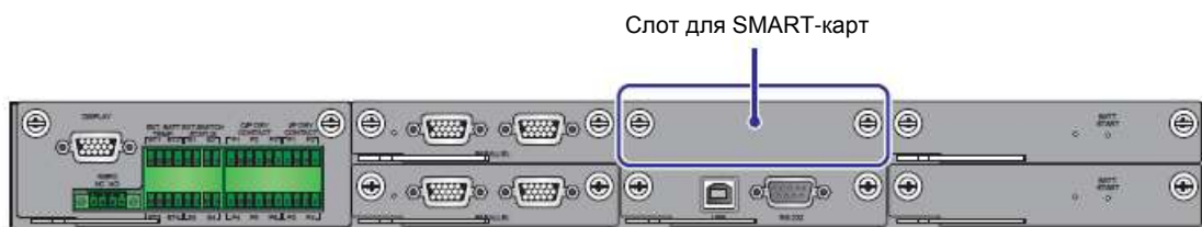
Рисунок 4-13: Расположение слота для SMART-карт
