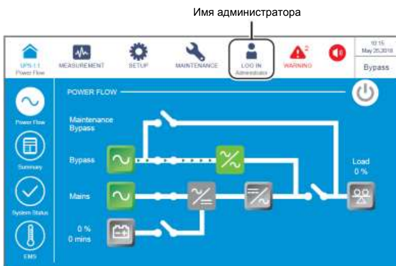
Рисунок 6-70: Экран байпасного режима и имя администратора
