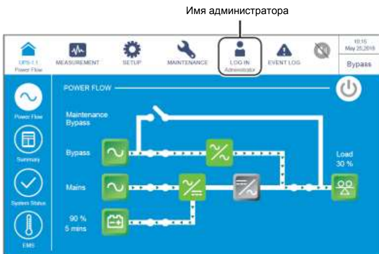
Рисунок 6-55: Экран байпасного режима и имя администратора
