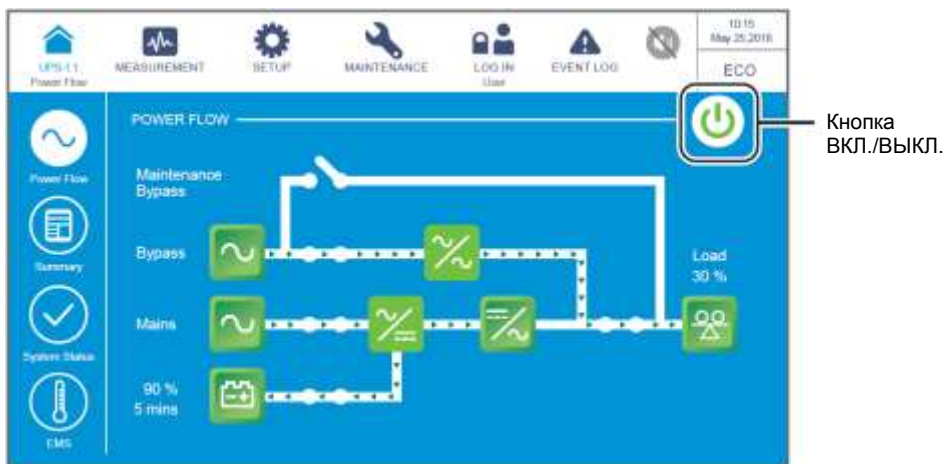
Рисунок 6-52: Экран ECO-режима и кнопка ВКЛ./ ВЫКЛ.
