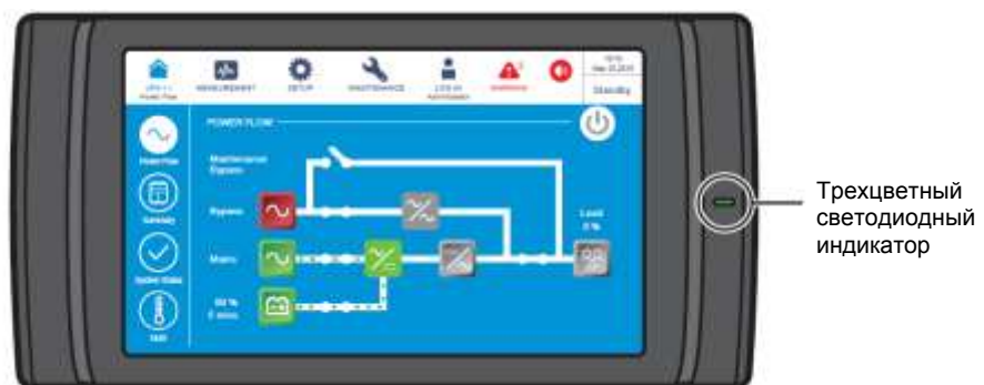
Рисунок 2-11: Расположение трехцветного светодиодного индикатора
