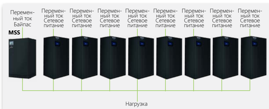
Централизованная параллельная конфигурация ИБП Liebert 80-eXL с главным статическим переключателем (MSS), состоящая из 8 параллельных ИБП
