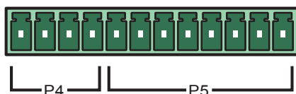
Рис. 4-7. Сухие контакты батареи
