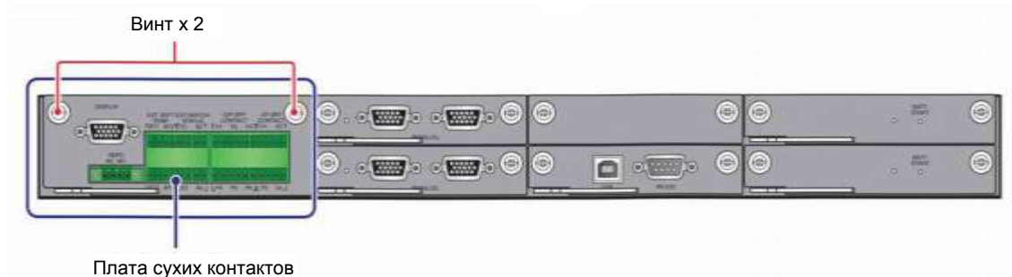
Рисунок 4-5: Расположение платы сухих контактов
