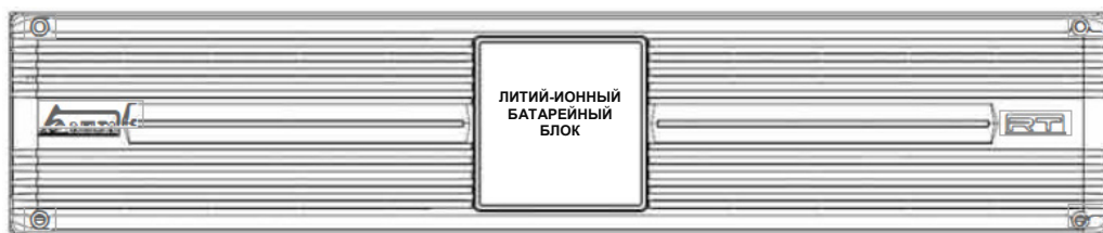
Рисунок 1-1. Литий-ионный батарейный блок Delta, вид спереди
