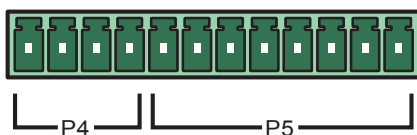
Рис. 4-7. Сухие контакты батареи
