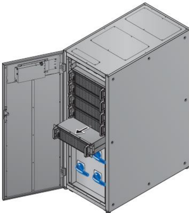
Рисунок 5-40: Демонтаж модуля STS
