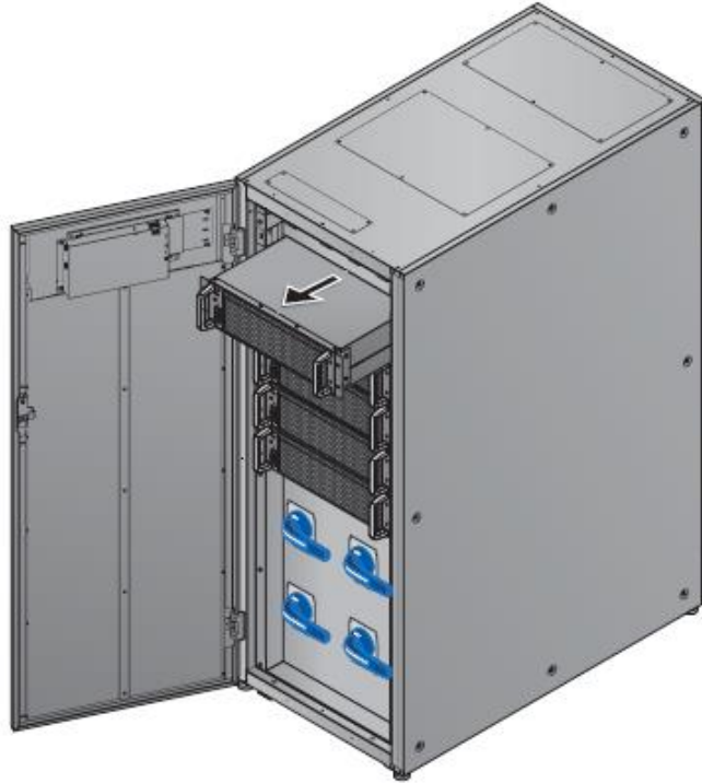
Рисунок 5-51: Демонтаж силового модуля
