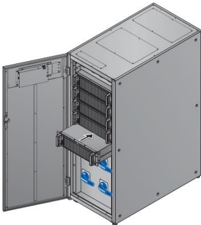
Рисунок 5-35: Установка модуля STS в ИБП
