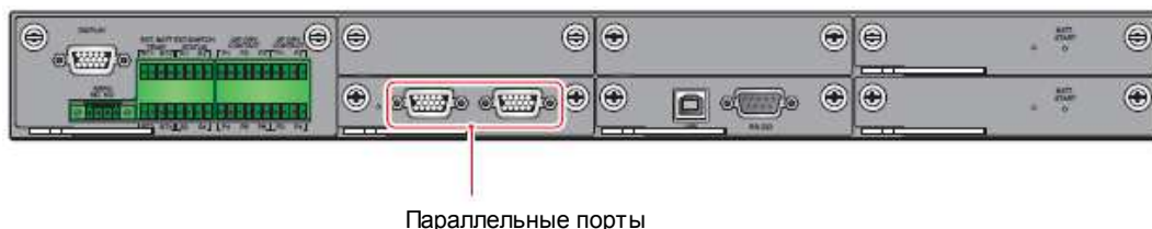
Рисунок 4-14: Расположение параллельных портов
