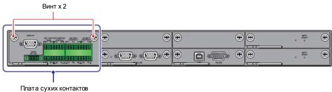
Рисунок 4-5: Расположение платы сухого контакта
