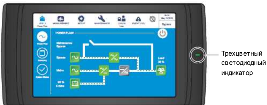
Рисунок 2-12: Расположение трехцветного светодиодного индикатора
