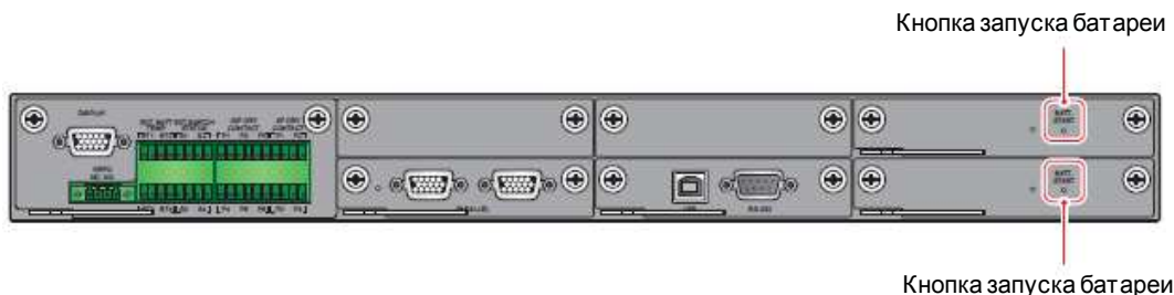
Рисунок 4-17: Расположение кнопок запуска батарей
