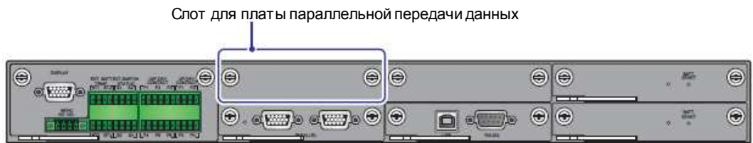
Рисунок 4-12: Расположение слота для платы параллельной передачи данных
