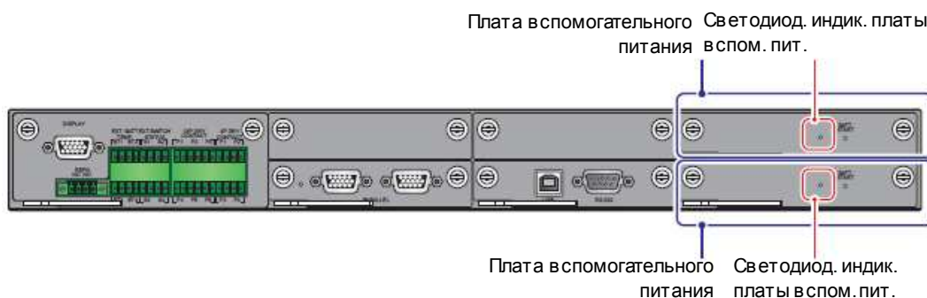
Рисунок 4-16: Расположение плат вспомогательного питания и их светодиодных индикаторов
