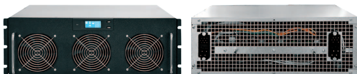
Силовой модуль HEM50X (50 кВА PF=0,9)
