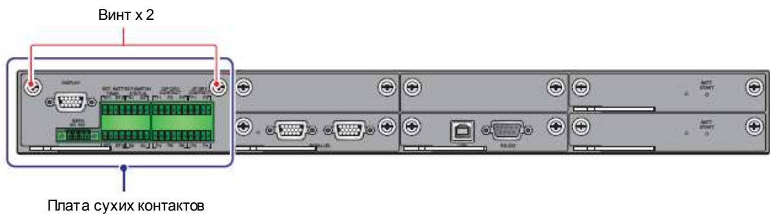
Рисунок 4-5: Расположение платы сухого контакта
