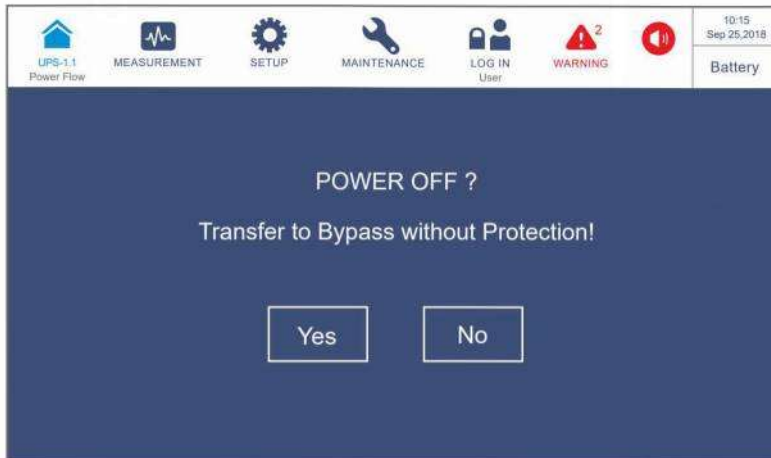
Рисунок 6-49: Экран с запросом об отключении
