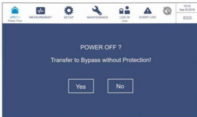
Рисунок 6-53: Экран с запросом об отключении
