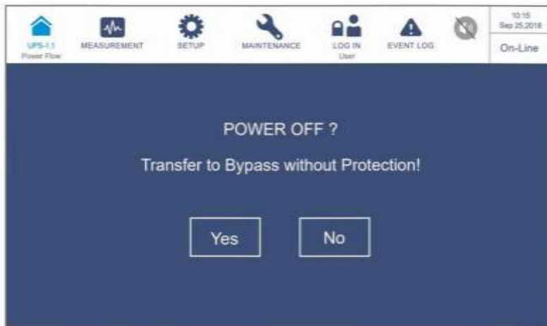
Рисунок 6-46: Экран с запросом об отключении
