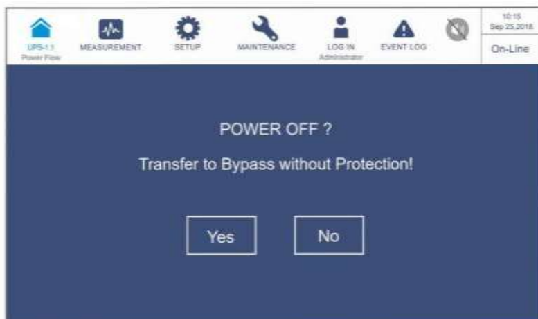
Рисунок 7-7: Окно напоминания выключения питания
