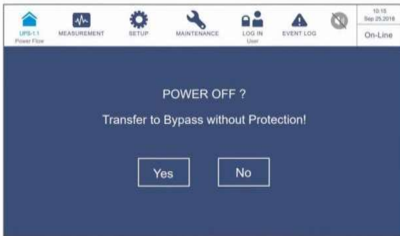
Рисунок 6-15: Экран с запросом об отключении
