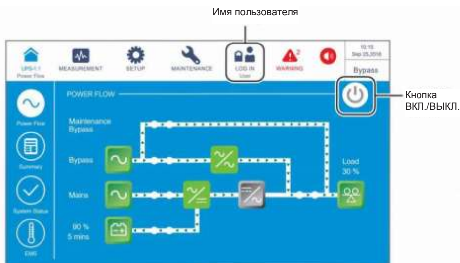
Рисунок 6-18: Экран режима байпаса: расположение кнопок имени пользователя и ВКЛ./ВЫКЛ.
