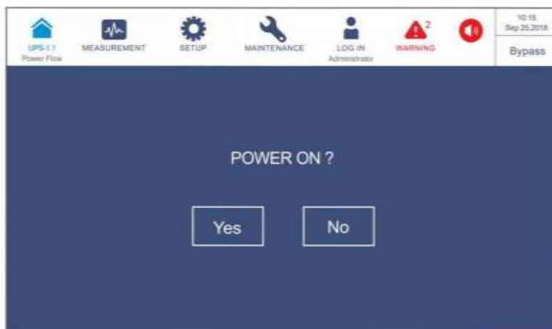
Рисунок 6-43: Экран с запросом о включении
