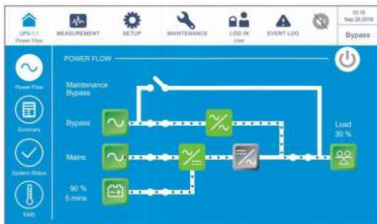
Рисунок 6-54: Экран байпасного режима
