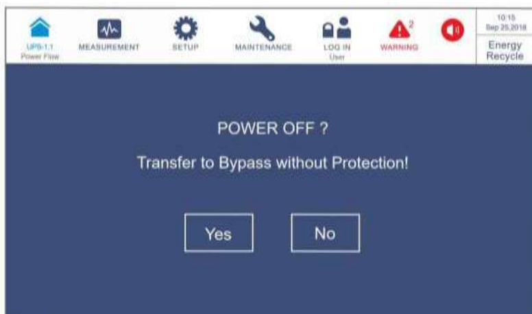
Рисунок 6-68: Экран с запросом об отключении
