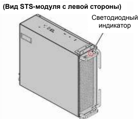
Рисунок 5-31: Расположение светодиодного индикатора модуля STS
