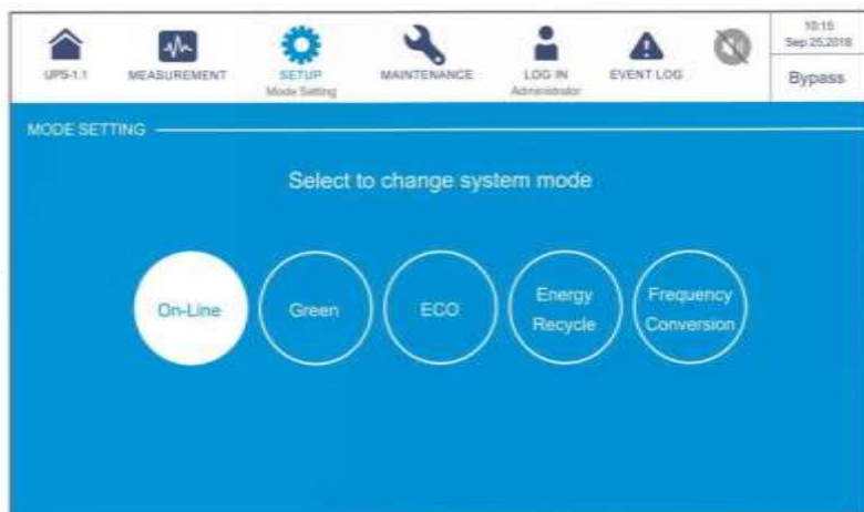
Рисунок 6-61: Выбор режима двойного преобразования
