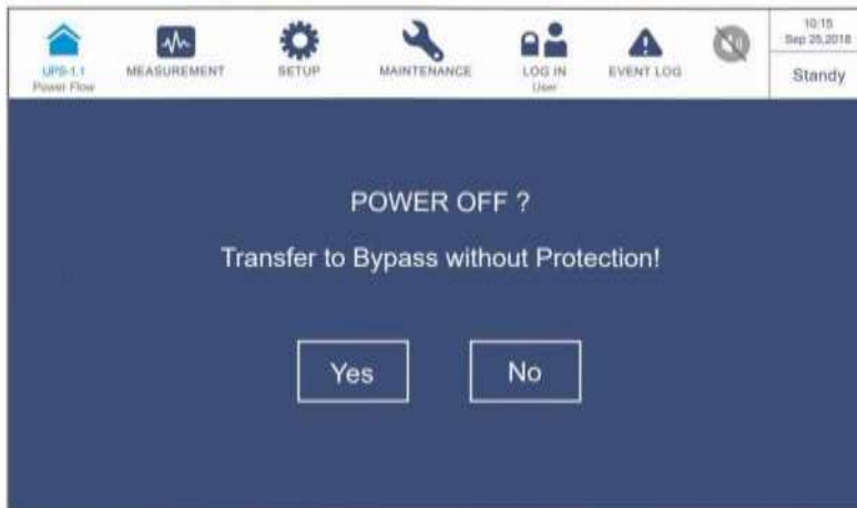
Рисунок 6-58: Экран с запросом об отключении
