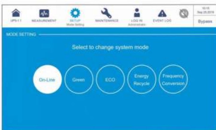
Рисунок 6-56: Выбор режима двойного преобразования
