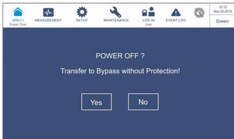
Рисунок 6-63: Экран с запросом об отключении
