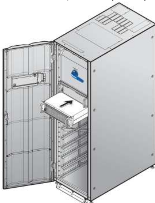
Рисунок 5-40: Установка силового модуля в ИБП
