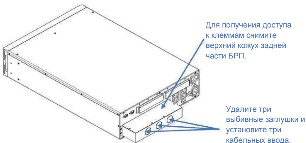
Рис. 6-6. Расположение верхнего кожуха задней части и трех выбивных заглушек на задней панели БРП
