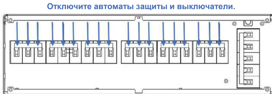
Рис. 8-3. Отключение автоматов защиты и выключателей на внутренней передней панели БРП
