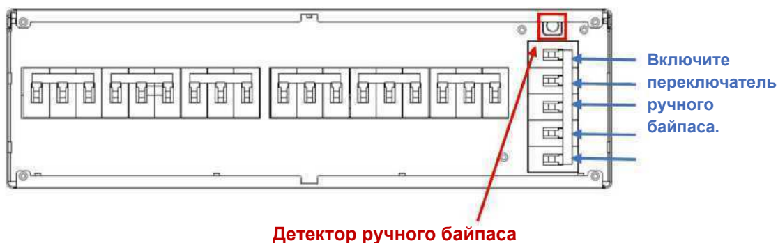
Рис. 8-2. Включение переключателя ручного байпаса БРП
