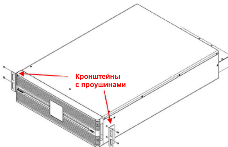
Рис. 5-1. Крепление кронштейнов с проушинами к БРП
