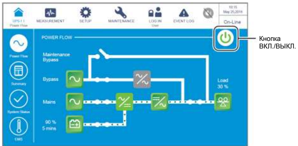
Рисунок 6-45: Экран режима двойного преобразования и расположение кнопки ВКЛ./ ВЫКЛ.
