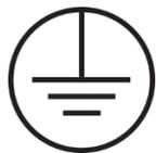
PE: Защитное заземление.
