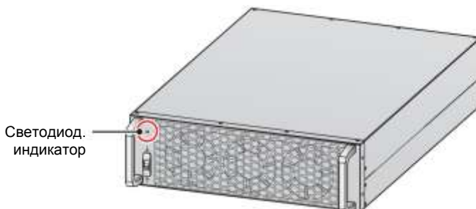
Рисунок 5-47: Светодиодный индикатор силового модуля
