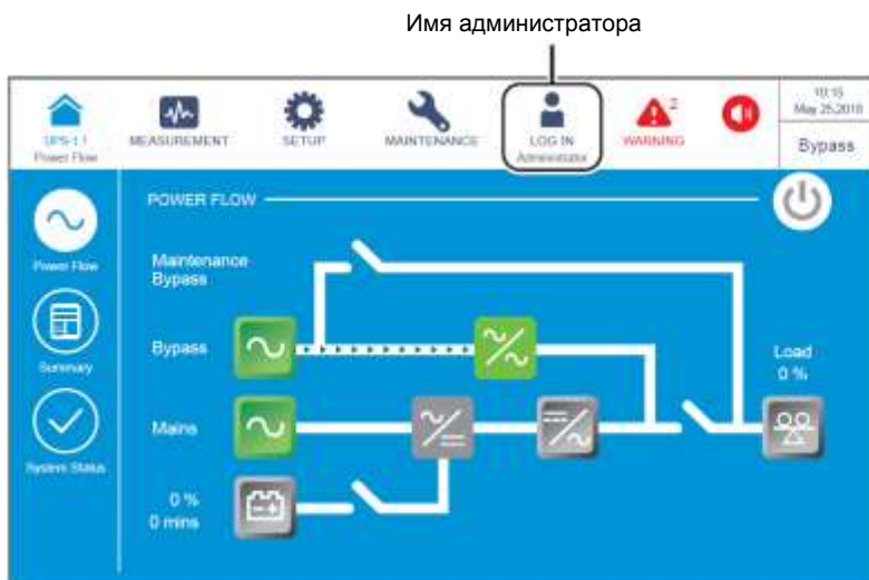
Рисунок 6-70: Экран байпасного режима и имя администратора
