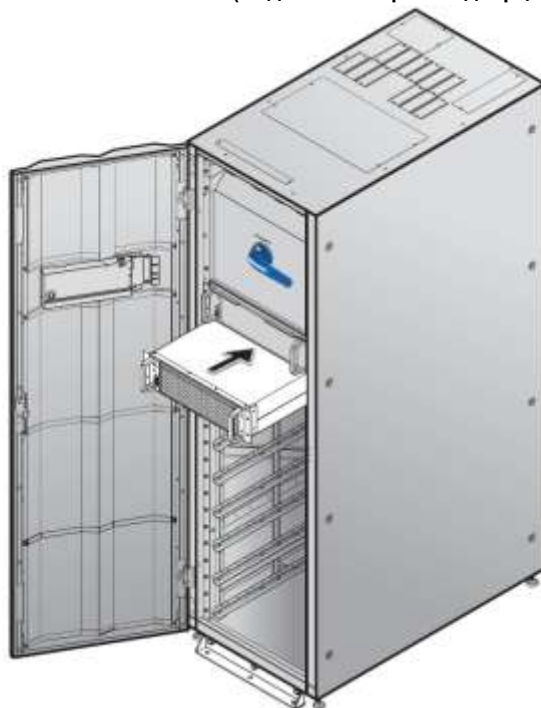
Рисунок 5-40: Установка силового модуля в ИБП
