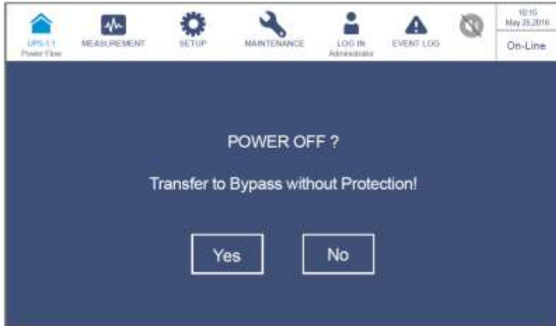
Рисунок 7-7: Окно с запросом о выключении питания
