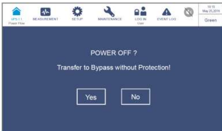
Рисунок 6-63: Экран с запросом об отключении
