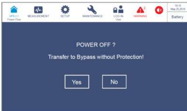
Рисунок 6-49: Экран с запросом об отключении
