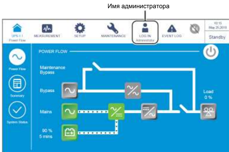
Рисунок 6-60: Экран режима ожидания и имя администратора
