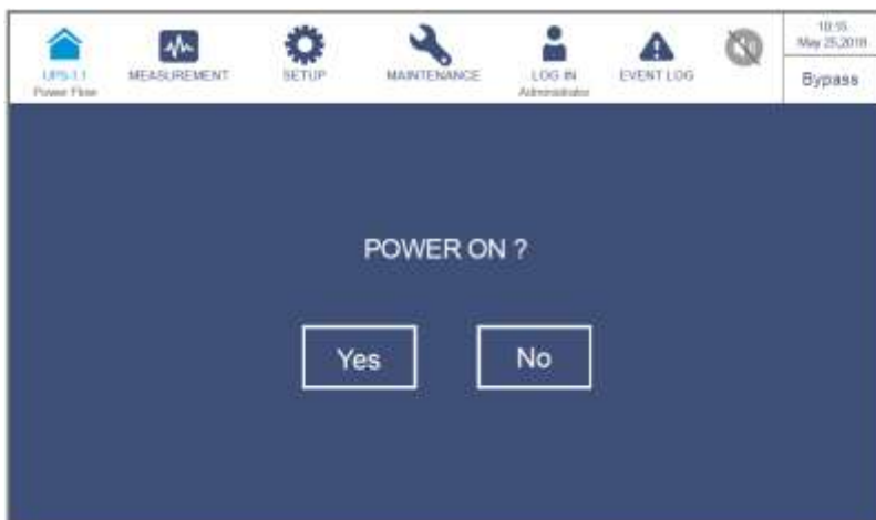
Рисунок 7-6: Окно с запросом о включении питания
