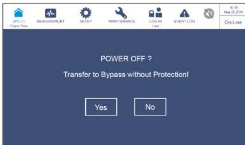
Рисунок 6-46: Экран с запросом об отключении
