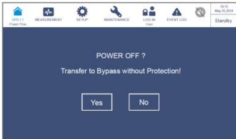
Рисунок 6-58: Экран с запросом об отключении
