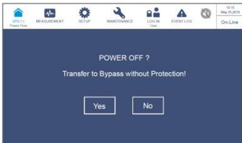
Рисунок 6-15: Экран с запросом об отключении
