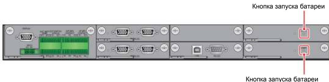
Рисунок 4-14: Расположение кнопок запуска батарей
