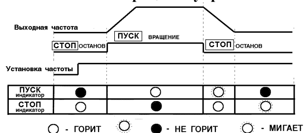
Рис. 11. Пояснения к пульту управления Изменение состояний световых индикаторов "ПУСК" и "СТОП" в процессе управления
