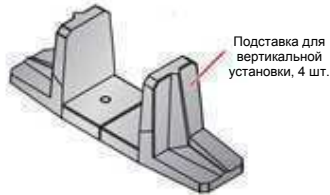
Рисунок 6-3. Сборка подставок для вертикальной установки ИБП 5/ 6/ 8/ 10 кВА
