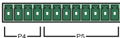
Рис. 4-7. Сухие контакты батареи
