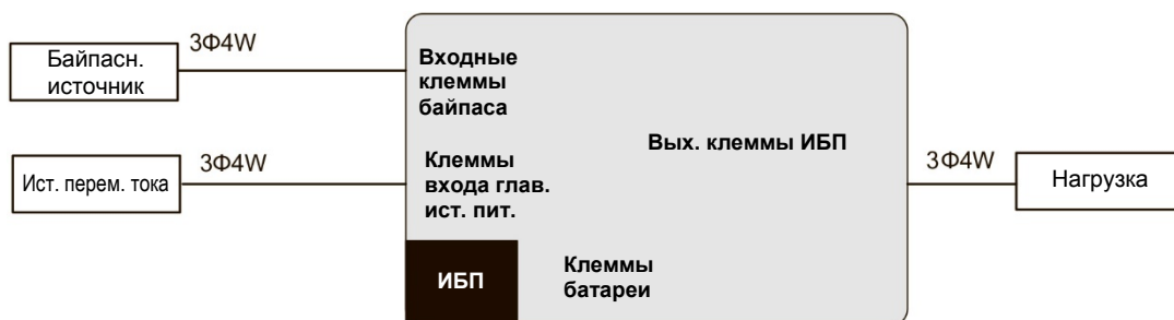
Рисунок 7-10. Схема проводки ИБП. Трехфазный выход и вход от двух источников питания
