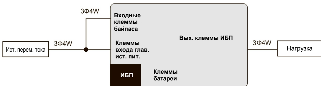
Рисунок 7-8 Схема проводки ИБП. Трехфазный выход и вход от одного источника питания
