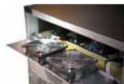
Резервирование вентилятора повышает надежность системы*
