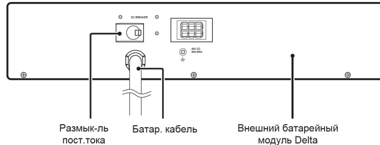
(Рисунок 8: Вид сзади внешнего батарейного модуля Delta)
