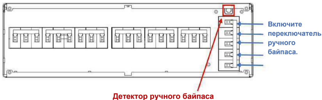
Рис. 8-2. Включение переключателя ручного байпаса БРП
