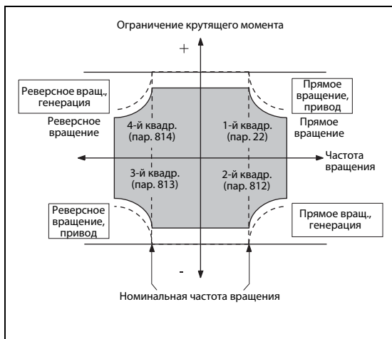
Рис. 5-14: Задание ограничения крутящего момента с помощью параметров
