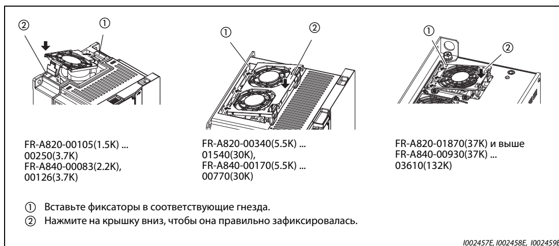
Рис. 7-6: Монтаж кожуха вентилятора
