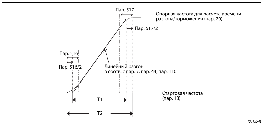
Рис. 5-90: Длительность S-образных участков характеристики при запуске
