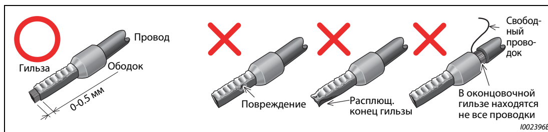
Рис. 2-28: Опрессовка оконцовочной гильзы
