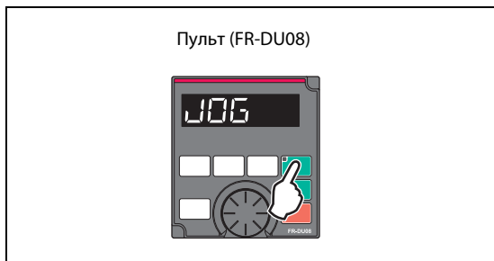
Рис. 4-13: Пример для толчкового включения с помощью пульта
