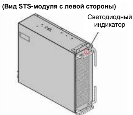
Рисунок 5-31: Расположение светодиодного индикатора модуля STS
