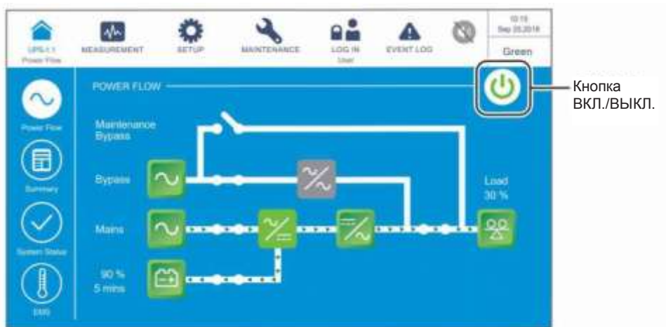
Рисунок 6-62: Экран энергосберегающего режима и кнопка ВКЛ./ВЫКЛ.
