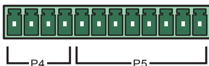
Рис. 4-7. Сухие контакты батареи
