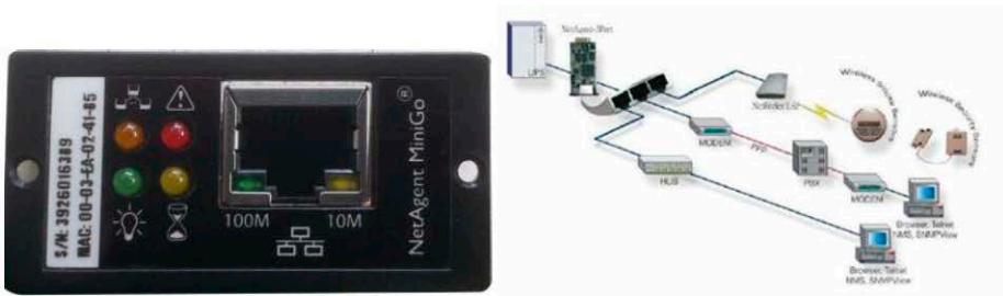
Рис 19. Внешний вид SNMP карты и примерная схема управления ИБП по сети.
