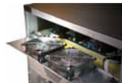
Резервирование вентилятора повышает надежность системы*
