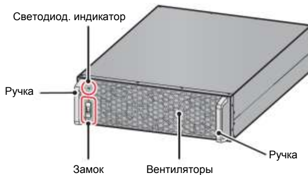
Рисунок 5-43: Силовой модуль (опция)
