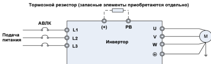
Рисунок 2. Схема подключения силовых цепей
