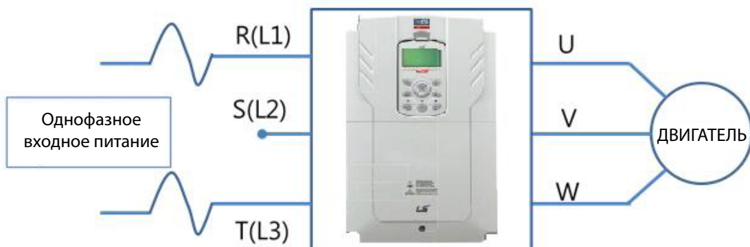
Рисунок 3. Схема подключения проводки к клеммам
