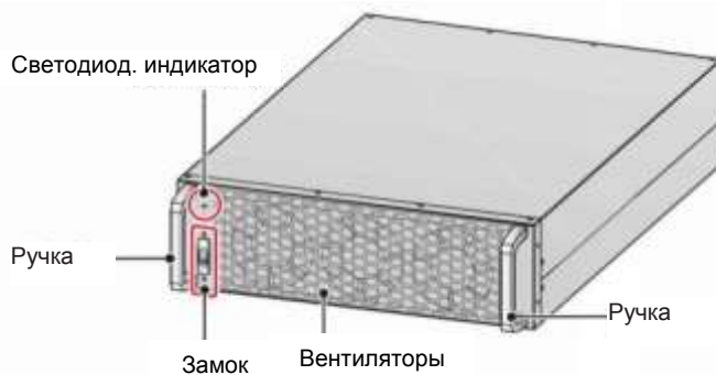
Рисунок 5-32: Силовой модуль (опция)
