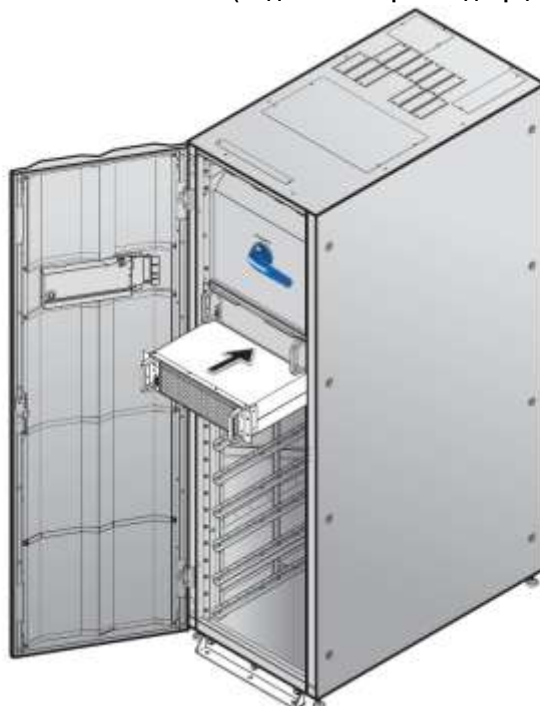
Рисунок 5-40: Установка силового модуля в ИБП
