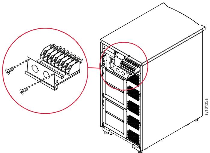
Пропустите кабелепровод соответствующего размера через отверстия для проводки в блоке коммутации.
