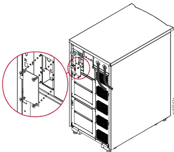
Для установки с использованием контакта внешнего выключателя подключите выключатель REPO к имеющейся перемычке.
