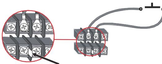
Для установки с использованием контакта выключателя и внешнего источника питания 24 V снимите перемычку и подключите выключатель REPO к внешнему источнику питания с помощью кабеля с кольцевым наконечником.
