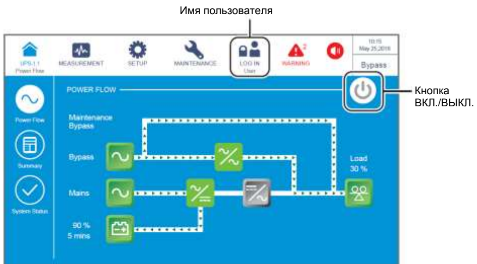
Рисунок 6-18: Экран ручного байпасного режима, кнопки имени пользователя и ВКЛ./ ВЫКЛ.
