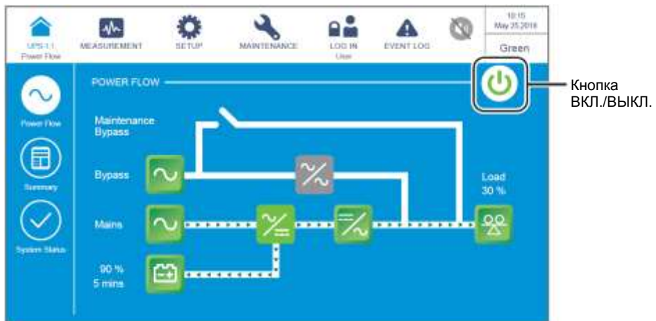
Рисунок 6-62: Экран энергосберегающего режима и кнопка ВКЛ./ВЫКЛ.
