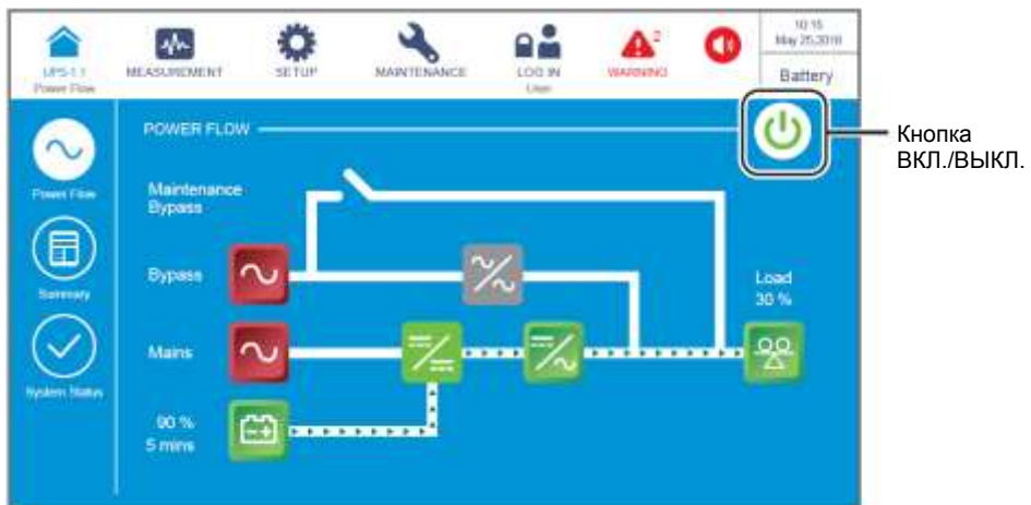
Рисунок 6-48: Экран батарейного режима и кнопка ВКЛ./ВЫКЛ.
