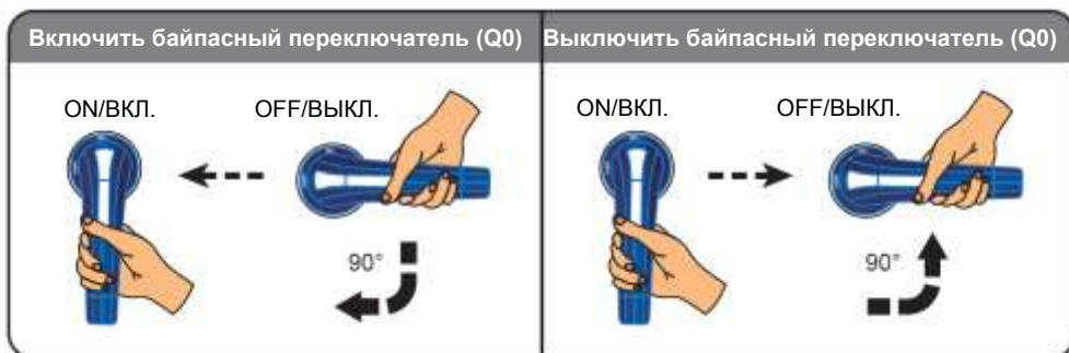
Рисунок 2-5: Включение/ выключение байпаса (Q0)
