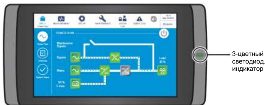
Рисунок 2-11: Расположение трехцветного светодиодного индикатора
