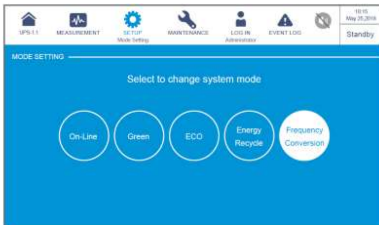
Рисунок 6-30: Выбор режима преобразования частоты
