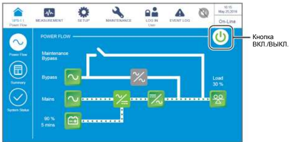
Рисунок 6-45: Экран режима двойного преобразования, кнопки имени пользователя и ВКЛ./ ВЫКЛ.
