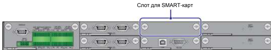
Рисунок 4-12: Расположение слота для SMART-карт
