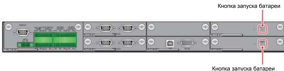
Рисунок 4-14: Расположение кнопок запуска батарей
