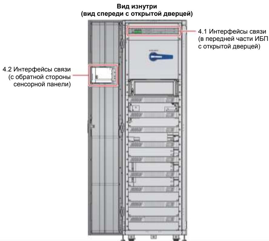
Рисунок 4-1: Расположение интерфейсов связи
