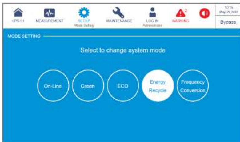
Рисунок 6-42: Выбор режима повторного использования электроэнергии
