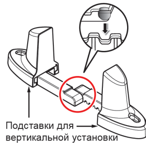
(Рисунок 4: Сборка подставок для вертикальной установки)
