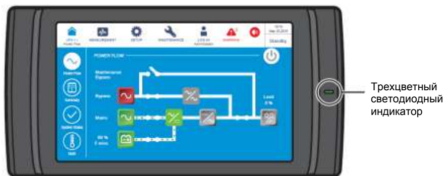
Рисунок 2-11: Расположение трехцветного светодиодного индикатора
