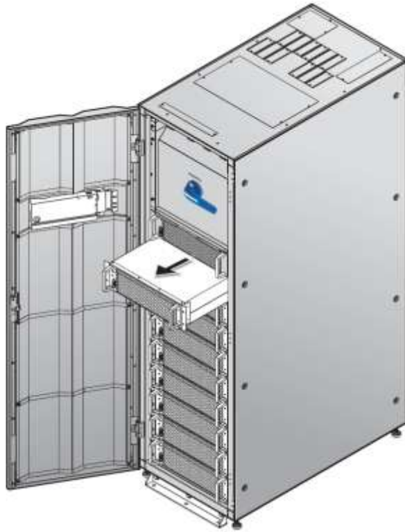
Рисунок 5-45: Демонтаж силового модуля
