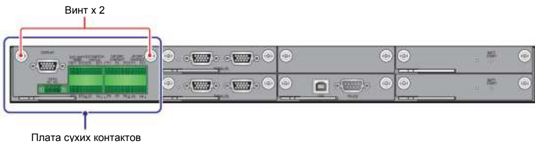
Рисунок 4-5: Расположение платы сухих контактов
