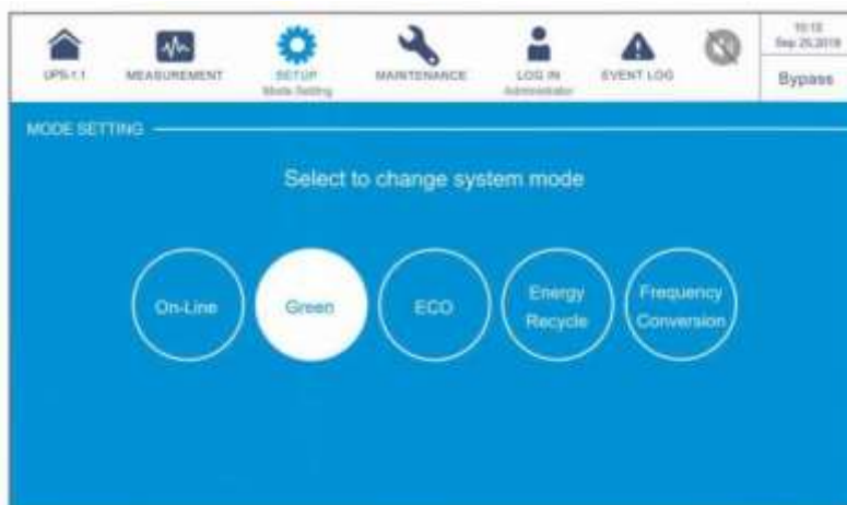
Рисунок 6-36: Выбор энергосберегающего режима
