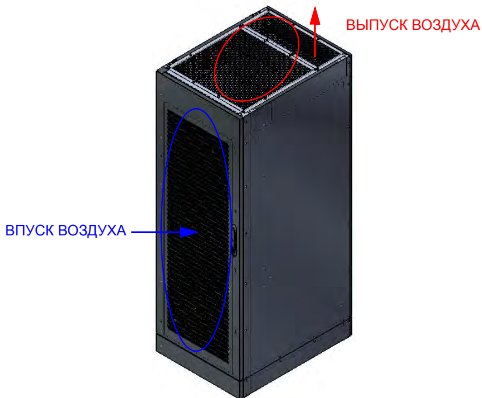
Рисунок 3 - ВПУСК/ВЫПУСК ВОЗДУХА - МОДУЛЬ
