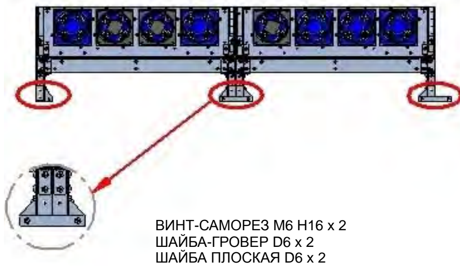
Рисунок 54 - Сборка НИЖНЕЙ ЧАСТИ – МОДУЛЬ с МОДУЛЕМ
