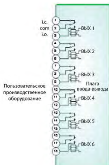
Рисунок 120 - Подключение разъема XP12
