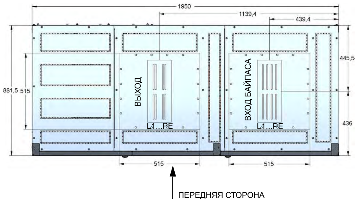
Рисунок 33 - РАЗМЕРЫ БЛОКА ВВОДА-ВЫВОДА 4000-5000 А (ВИД СВЕРХУ С ФЛАНЦАМИ) см. "ПРИМЕЧАНИЕ" на стр. 127
