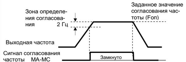
Заданное значение согласования частоты – значение опорной частоты, установленное, как основное задание частоты (F21), либо любое из “задание частоты 2”... “задание частоты 8” (F22...F28).
