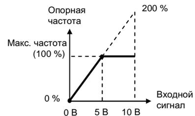
(2) Опорная частота 50...100 % задается входным сигналом 0...10 В.
