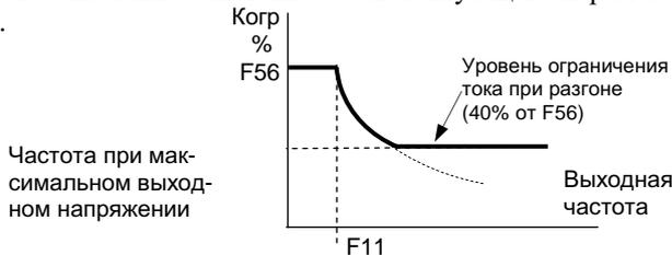
(3) Предотвращение срыва (ограничение тока) при работе на постоянной скорости. Параметр **F57**.
