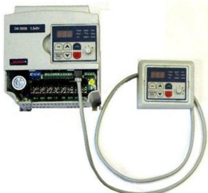
Выносной пульт управления ПУ-8100П применим только совместно с моделью **E3-8100** и предназначен для копирования параметров ПЧ, а так же для удалённой (до 1 метра) работы с ПЧ вместо штатного пульта управления ПУ-8100, при этом работа последнего блокируется (возможно только считывание показаний дисплея и контроль состояния световых индикаторов). Подключение ПУ-8100П производится штатным соединительным кабелем длиной 1м.
