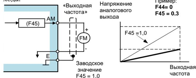
Устанавливается напряжение аналогового выхода частоты при выходной частоте преобразователя 100%. Для приведенного выше примера индикация 0...(F09) Гц будет соответствовать сигналу 0...3 В:
