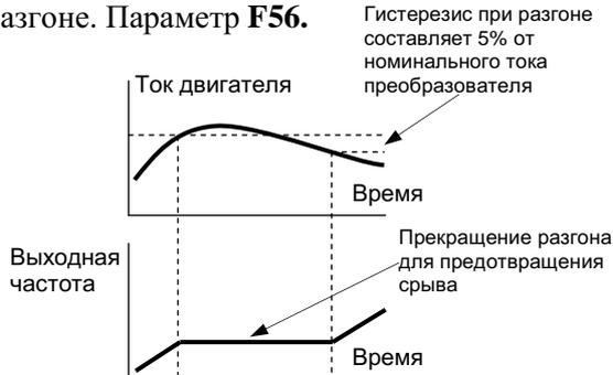
В зоне постоянной выходной мощности (выходная частота F21 больше частоты при максимальном выходном напряжении F11) уровень ограничения тока автоматически снижается по нижеприведённой зависимости:
