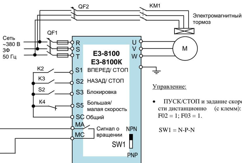
Схема для конвейерного применения
