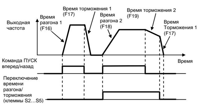
При выбранном способе останова - плавный останов с торможением (F04 = 0).
