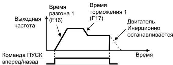
После снятия команды ПУСК ВПЕРЕД (НАЗАД) силовое напряжение мгновенно снимается с выхода частотного преобразователя и электродвигатель инерционно останавливается.
