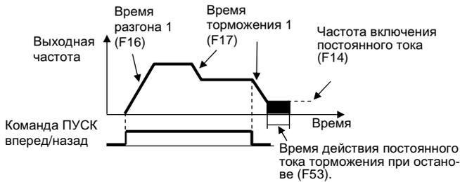
В примере показано время разгона/торможения 1. После снятия команды ПУСК ВПЕРЕД(НАЗАД) электродвигатель плавно останавливается с темпом торможения, соответствующим установленному времени торможения (F16), и торможение постоянным током включается непосредственно перед остановом. Если время останова мало или инерция нагрузки велика, при торможении может появиться ошибка перенапряжения (OV). В этом случае необходимо увеличить время торможения либо подключить тормозной резистор.
