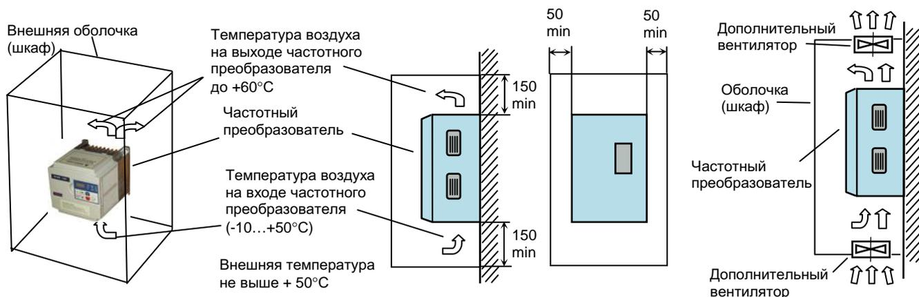
Внешняя оболочка, изолирующая преобразователь от воздушного внешнего пространства, должна иметь размеры, достаточные для рассеивания тепла. Минимальные размеры оболочки определяются мощностью установленного преобразователя и допустимой разностью  $\Delta T$  между температурой внутри оболочки и температурой внешнего воздуха. При уменьшении  $\Delta T$  минимальные размеры оболочки должны быть увеличены.
