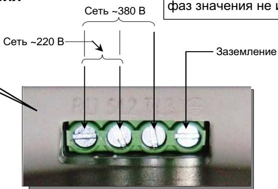
**Клеммы подключения электродвигателя**
