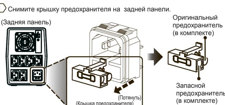
2 Замените оригинал предохранитель ① запасным из комплекта ②.
