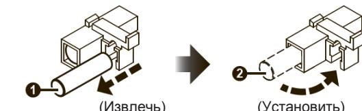
3 Установите крышку предохранителя на задней панели.
