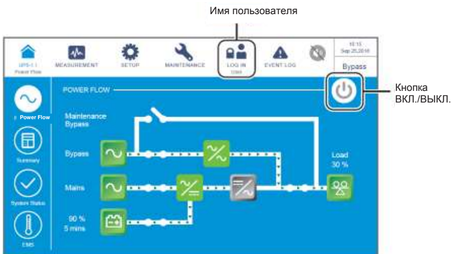
Рисунок 6-3: Главный экран: расположение кнопок имени пользователя и ВКЛ./ВЫКЛ.
