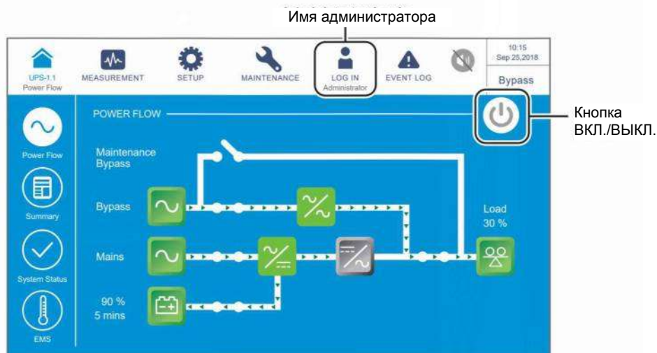
Рисунок 6-23: Главный экран: расположение кнопок имени администратора и ВКЛ./ВЫКЛ.
