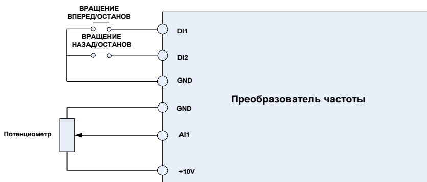
Рисунок 4. Схема подключения цепи управления
